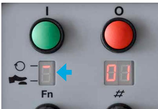
1. Tourner le potentiomètre jusqu'à l'indicateur du symbole 'cycle automatique'
