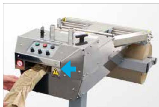
4. Retirer la bande de papier et la machine produira automatiquement une autre bande.
