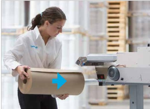
1. Retirer le tube de carton du précédent rouleau et en suivant le sens de déroulement, faire glisser un nouveau rouleau de papier sur le bras de chargement jusqu'au loquet et remonter ce loquet.
