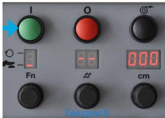
4. Appuyer sur le bouton vert de mise en marche pour activer la machine. L'écran va s'allumer. Si l'écran clignote et affiche des 'tirets' cela signifie que la machine doit être chargée avec un rouleau de papier.
