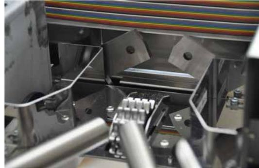
**6.** Replacer les galets en vous assurant que les vis de fixation soient bien serrées.
