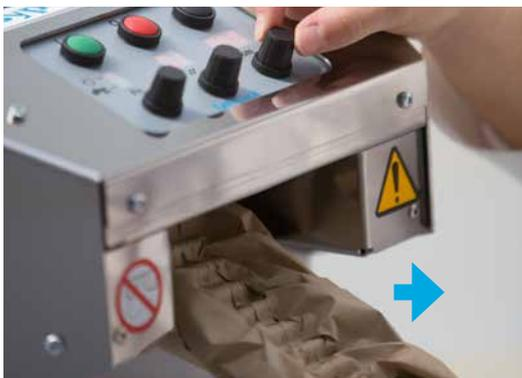
3. La bande de papier peut sortir de la machine par la trappe de sortie sans aucune contrainte
