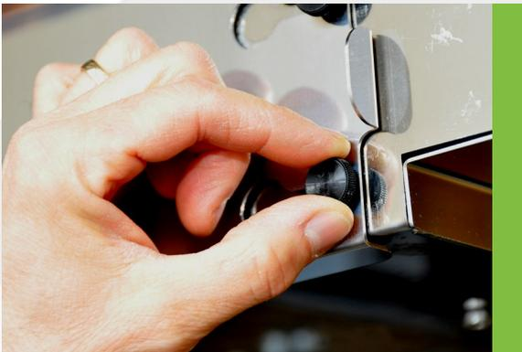
1. Afloje las dos perillas negras que aseguran la puerta de recortes de papel debajo del canal de salida.
