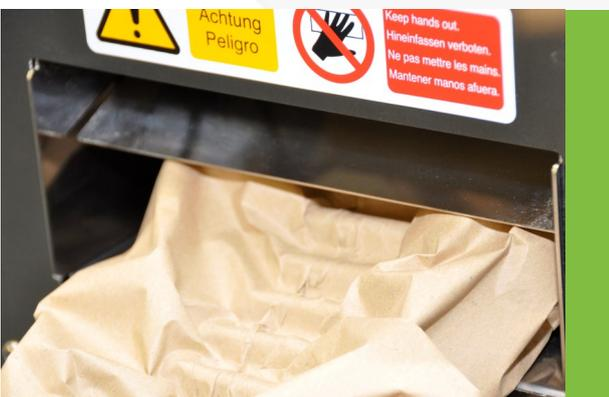
4. La máquina no se encenderá o pondrá en funcionamiento con la compuerta de salida abierta.
