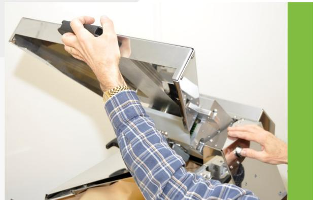
3. La máquina no se encenderá o funcionará con la cubierta superior levantada.
