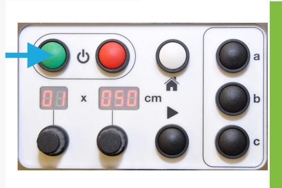
4. Encienda la máquina pulsando el botón 'Encendido' verde. Se iluminará el visualizador. Si el visualizador muestra 'rayas' parpadeantes, es necesario cargar la máquina con un rollo de papel.
