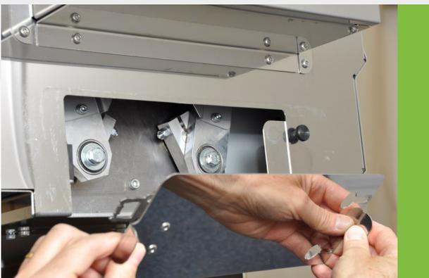
2. La máquina no se encenderá o funcionará con la puerta de recortes de papel abierta.
