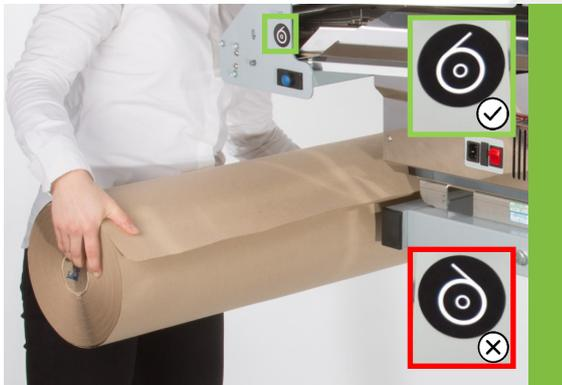
1. Teniendo presente la dirección en que se desenrolla, deslice un nuevo rollo de papel en el brazo de soporte del papel hasta que se active el resorte del trinquete de seguridad.
