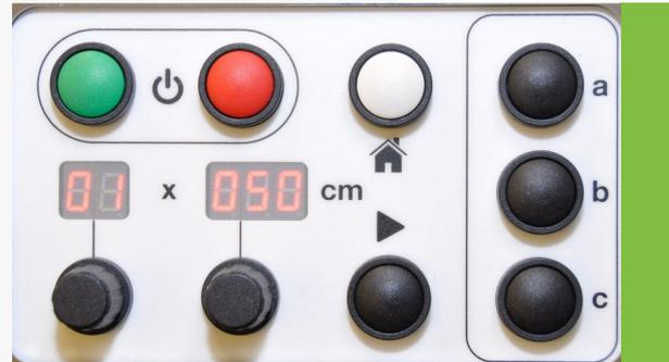
4. Deje de pulsar el botón de preajuste para guardar los valores - el visualizador parpadeará dos veces antes de mantenerse encendido.
