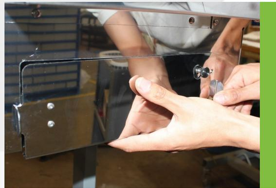
2. Deslice la puerta hacia la derecha para soltar la lengüeta de la llave del interruptor de seguridad.
