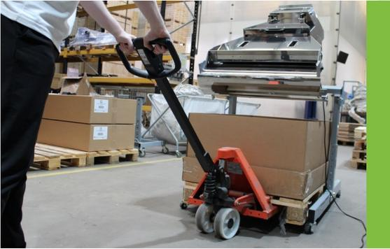
1. Utilizzando un transpallet idraulico, sollevare il bancale di carta e allinearlo al telaio.
