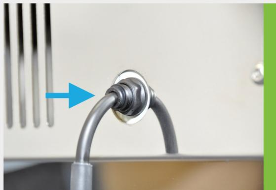
2. Il tubo dell'interruttore a pedale è collegato alla macchina.
