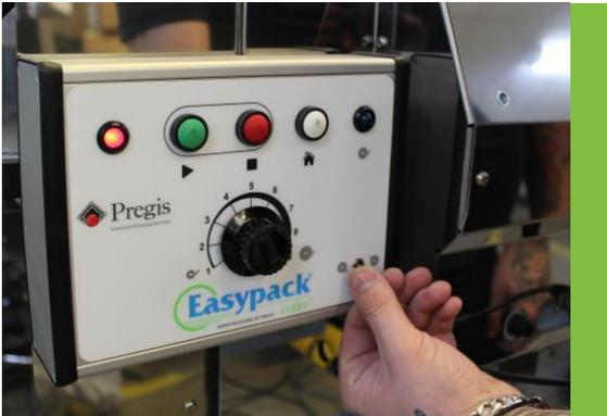
1. Selezionare la posizione della coda utilizzando l'interruttore di posizione della coda.
