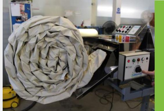
2. Interrupteur à gauche (position normale) : La bobine est terminée avec la queue maintenue en position basse jusqu'à ce que la bobine soit retirée.
