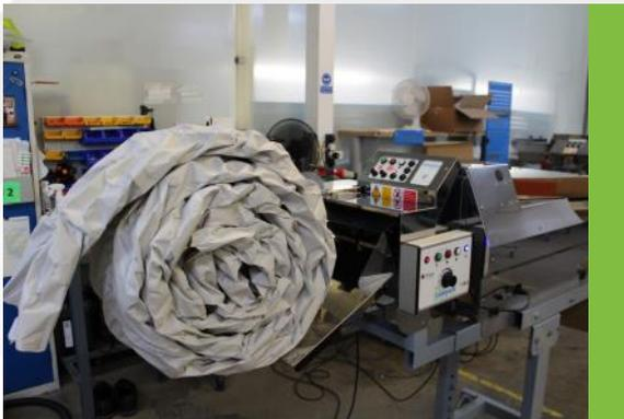
3. Interrupteur à droite : La bobine est terminée avec la queue maintenue en position haute permettant l'accès pour fixer manuellement l'extrémité de la bobine avec un ruban adhésif.
