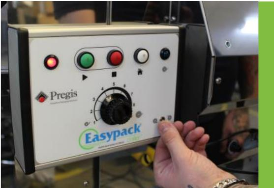
1. Sélectionner la position de la queue à l'aide de l'interrupteur de position de queue.
