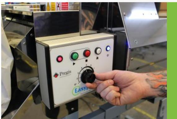
5. Sélectionner la taille de bobine requise à l'aide du bouton de sélection de la taille de bobine.
