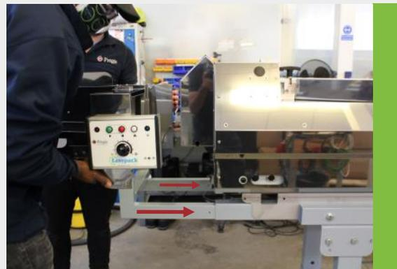
2. Aligner et connecter les barres de support du Coiler-lite avec les barres de support nouvellement ajoutées du Packmaster™ Pro.
