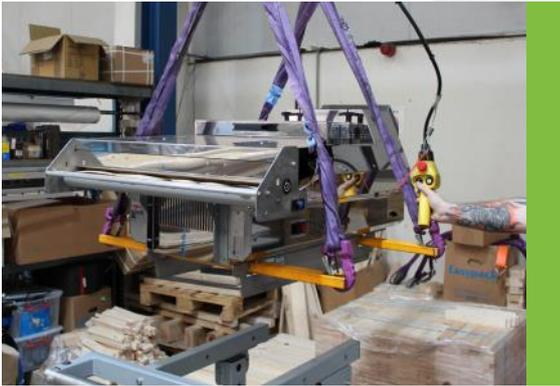
1. À l'aide d'un palan, soulever et aligner le Packmaster™ Pro avec son châssis.
