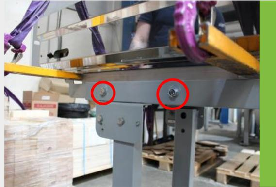
2. Retirer les boulons existants de chaque côté et les remplacer par des boulons M12 x 110 mm.
