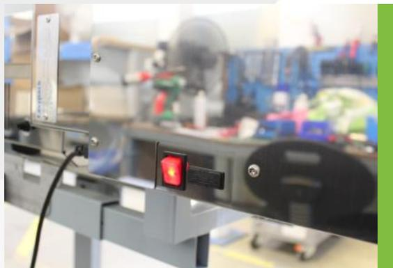
3. Brancher à l'alimentation secteur et allumer le Coiler-lite, puis vérifier si le voyant de l'interrupteur est allumé.
