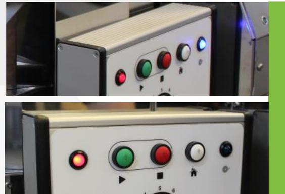
4. Lorsque la bobine est terminée et enroulée avec la position de queue sélectionnée, l'indicateur lumineux de bobine commencera à clignoter, indiquant qu'une action de l'opérateur est nécessaire pour retirer la bobine.
