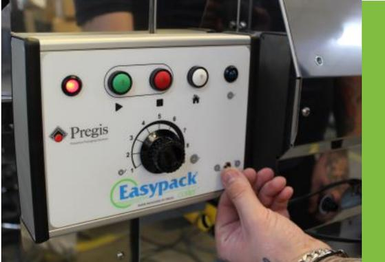
1. Seleccione la posición de la cola mediante el interruptor de posición de cola.
