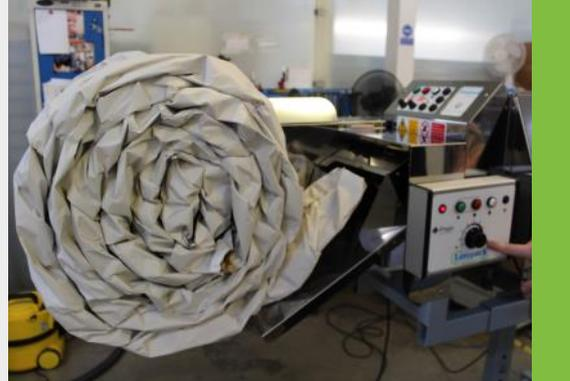
2. Interruptor hacia la izquierda (posición normal): la bobina se completa con la cola en la posición inferior que mantiene la cola en posición hasta que se retira la bobina.
