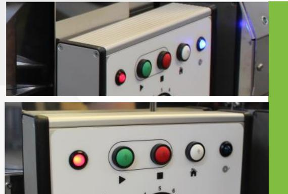
4. Cuando la bobina está completa y enrollada en la posición de cola seleccionada, el indicador de bobina comenzará a parpadear indicando que se requiere la acción del operador para retirar la bobina.
