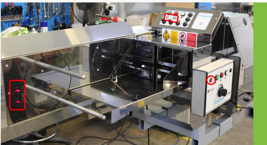
4. Asegúrese de que se encienden las luces del sensor, la luz de la consola de control y los indicadores de la consola de Packmaster Pro.
