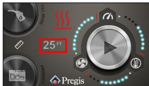
**Figura 20.** Sia la lunghezza che il tempo di funzionamento possono essere regolati selezionando l'icona **Tempo di funzionamento/Lunghezza**.
