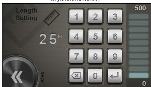
**Figura 21.** La modalità **Lunghezza** consente all'utente di selezionare la lunghezza impostata del cuscino ogni volta che viene premuto il pulsante **Start**.
