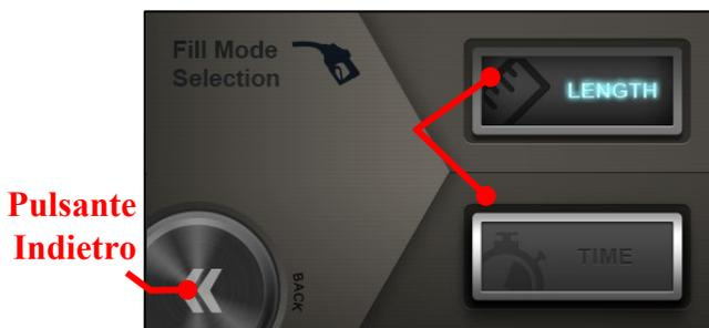
**Figura 19.** Il menu **Selezione modalità riempimento** consente all'utente di alternare tra lunghezza e tempo di funzionamento.
