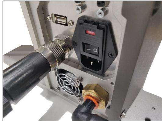
*Figura 7. Collegamento della pompa dell'aria alla parte posteriore della macchina.*
