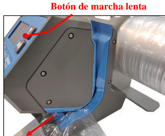
Figura 15. Utilice el botón de marcha lenta para que el resto de la película pase por la máquina.
