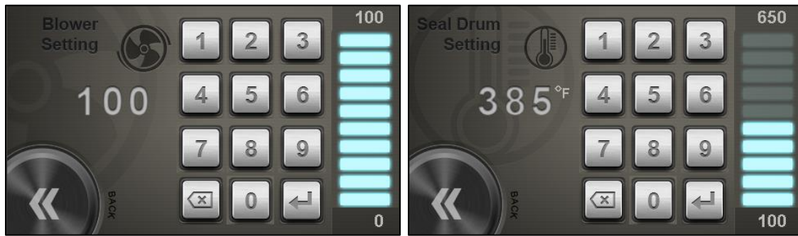
Figura 23. Introduzca el valor deseado, pulse la tecla intro y vuelva a la pantalla de inicio con el botón regresar .
