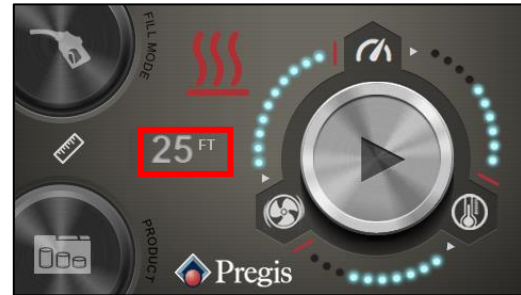
Figura 20. Tanto la duración como el tiempo de funcionamiento se pueden ajustar seleccionando el icono tiempo de ejecución/longitud.
