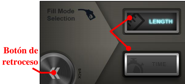
Figura 19. El usuario puede alternar entre la longitud y tiempo de funcionamiento en el menú de selección del modo de llenado.
