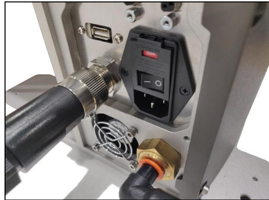
Figura 7. Conexión de la bomba de aire a la parte trasera de la máquina.
